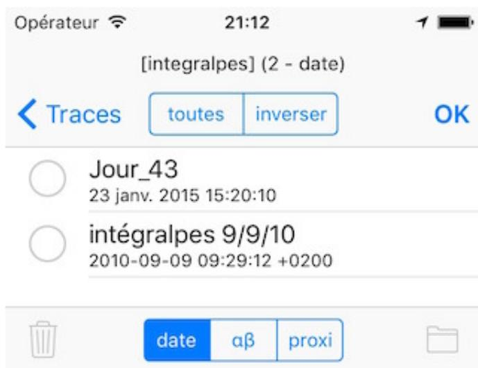
En mode modification, la barre d'outils inférieure qui apparaît comporte un sélecteur de mode de tri. Il y a trois mode de tri: par date, alphabétique et par proximité.
