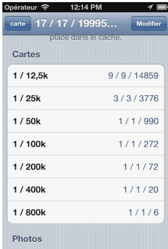
Au bas de la fiche, on trouve le détails des tuiles par échelles et par couches. Les nombres affichés sont sur le même format expliqué plus haut: tuiles en cache provision / tuiles en mémoire / tuiles dans l'emprise pour l'échelle.
